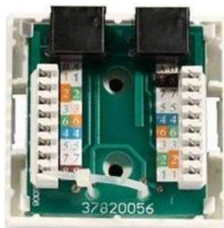
Рисунок 11 - Цветовая маркировка проводов розетки стандарта T568B это: 1 бело-ор, 2 ор, 3 бело-зел, 4 син, 5 бело-син 6 зел 7 бело кор, 8 кор
