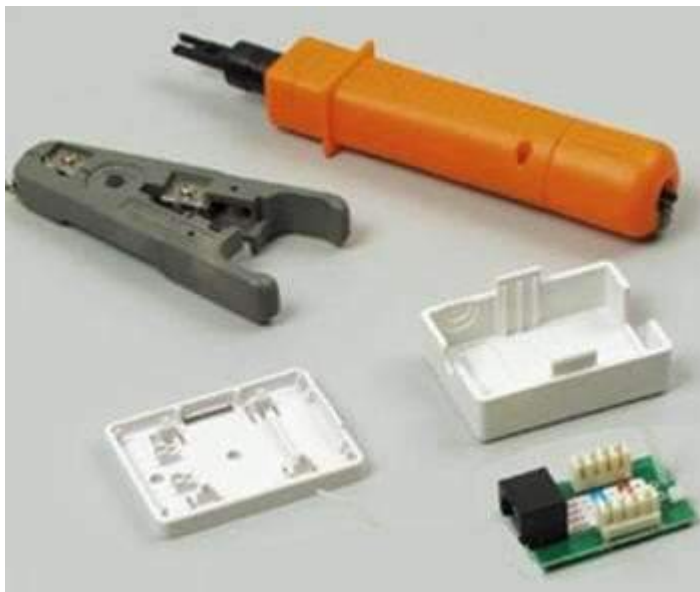
Рисунок 8 - Набор для монтажа розетки (слева инструмент для снятия изоляции, сверху – для обрезки концов проводников)
